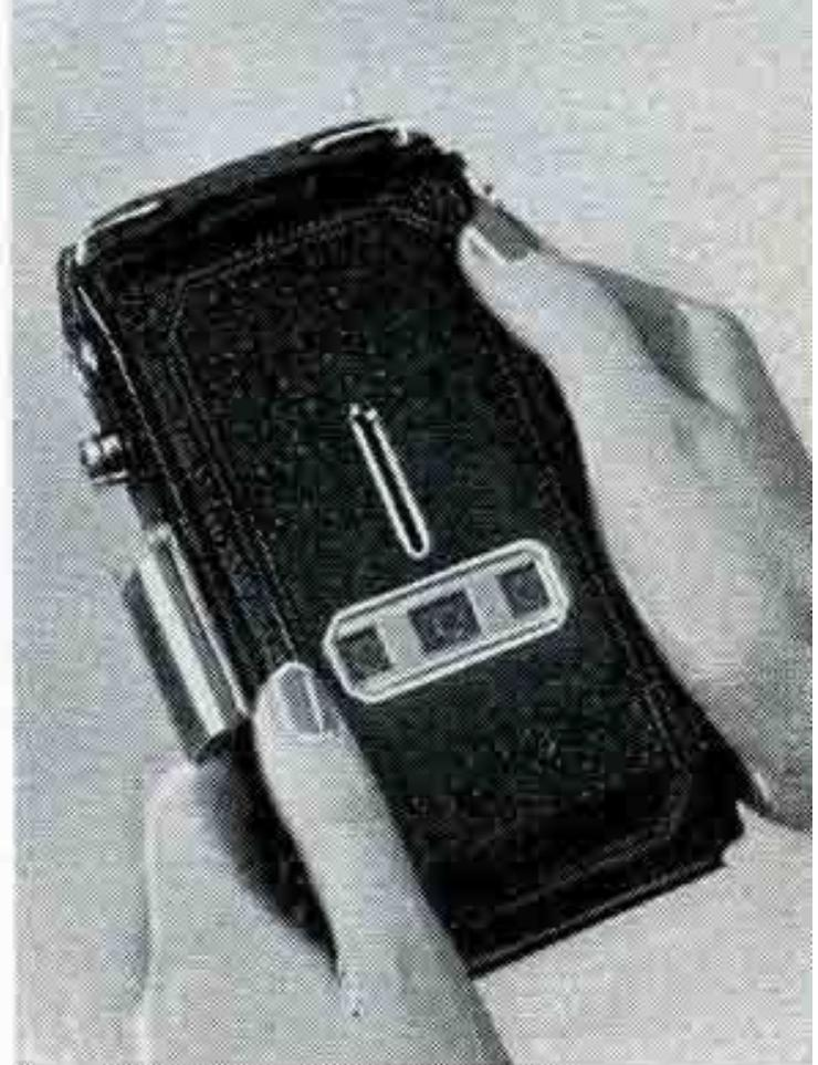
la fenêtre de prise de vue, l'ergot à droite (Fig. 2). Prenez soin de bien vérifier si le cadre repose bien à plat et si les rouleaux guide-film tournent bien. Le cache-voyant doit être fermé complètement (cercles blancs dans les trois voyants) (Fig. 3).
