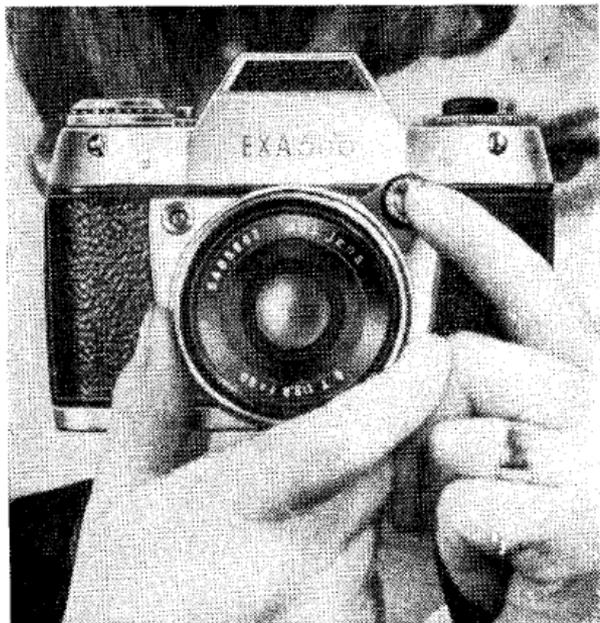
2. La mise au point s'effectue par rotation de la bague des distances (6). Elle est contrôlée sur le verre dépoli (12) où l'image doit apparaître parfaitement nette.
