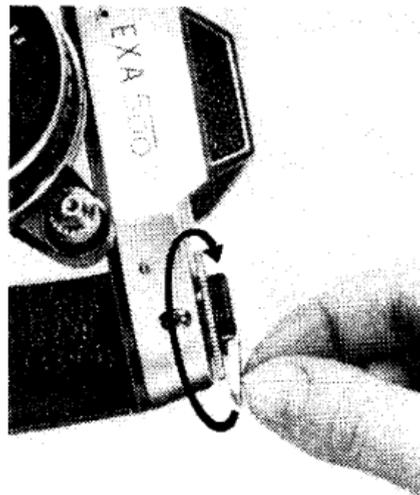
2. Tirer la manivelle de réenroulement (14) jusqu'à la butée, puis la tourner dans le sens de la flèche jusqu'au complet rebobinage du film (perceptible à une moindre résistance).
